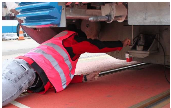
Bild 7: Montage des Sensors mittels Magnethalterung unter der Tram
