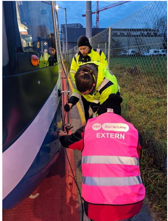
Bild 6: Montage des Sensors mittels Saugnapfhalterung
