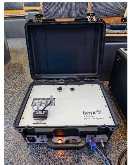
Bild 5: Messkoffer mit TMX-BrakeTest-System
